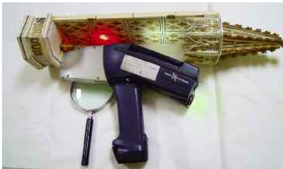
FIG. 1 - Lo spettrometro XRF durante una misura sulla base del tabernacolo
