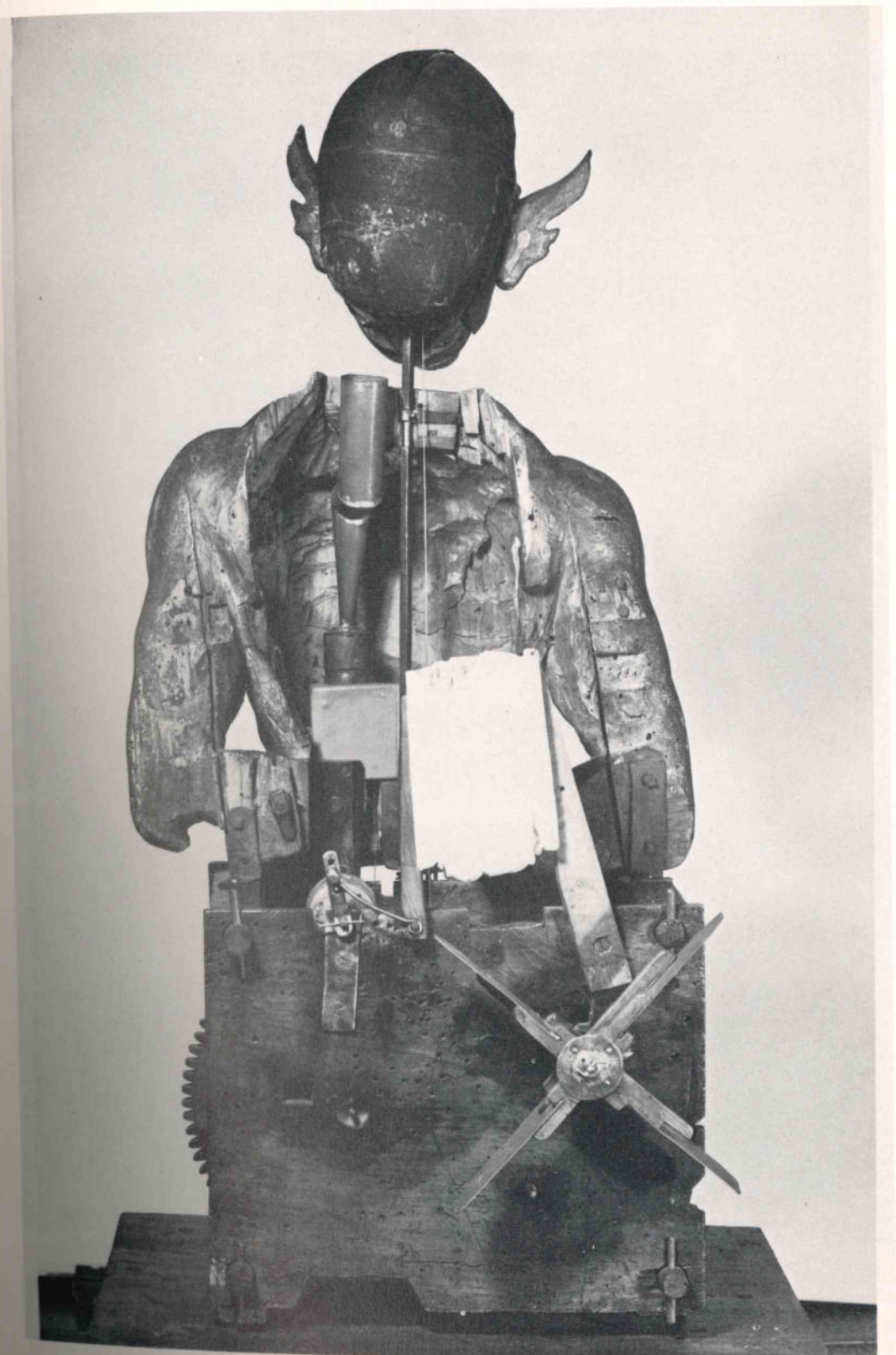
FIG. 5 - Parte posteriore dell'automa per mostrare il meccanismo.
