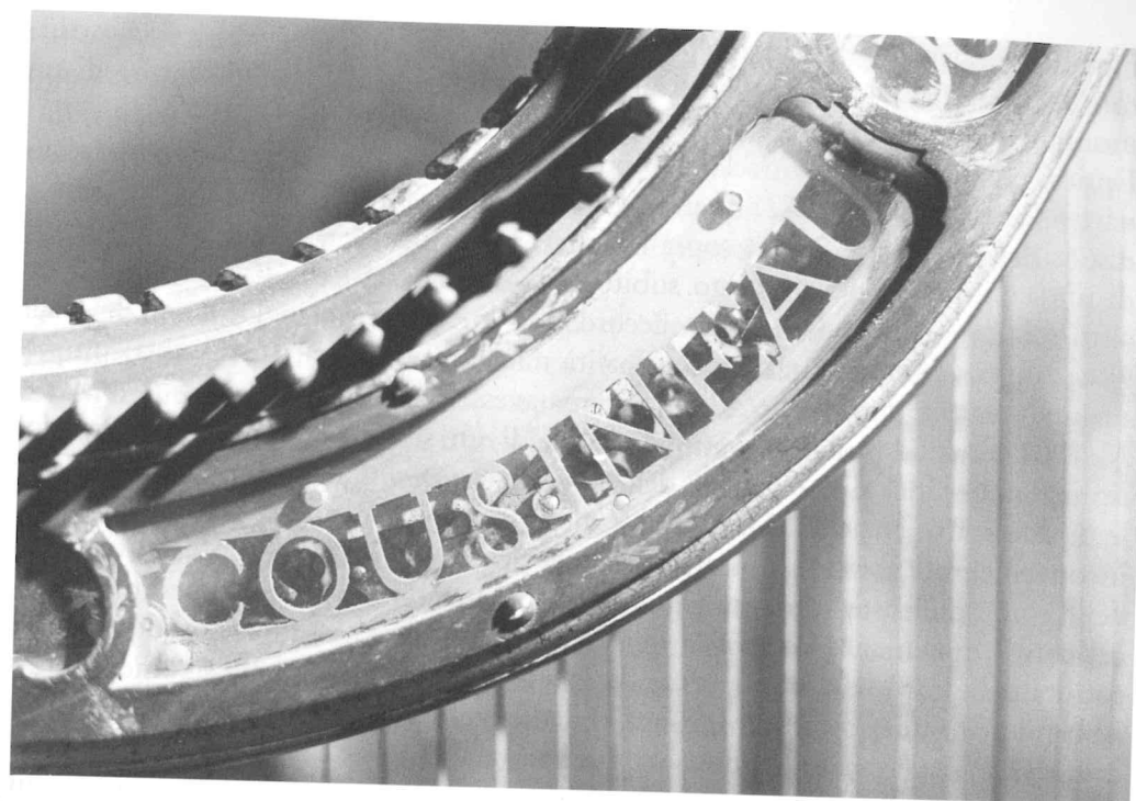
FIG. 14 - Inv. n. 299. Dettaglio del lato dx. del modiglione; il nome del costruttore è traforato su una lastra di ottone, a sua volta ricoperta da un cristallo che lascia intravedere le leve del meccanismo. Civico Museo degli Strumenti Musicali.
