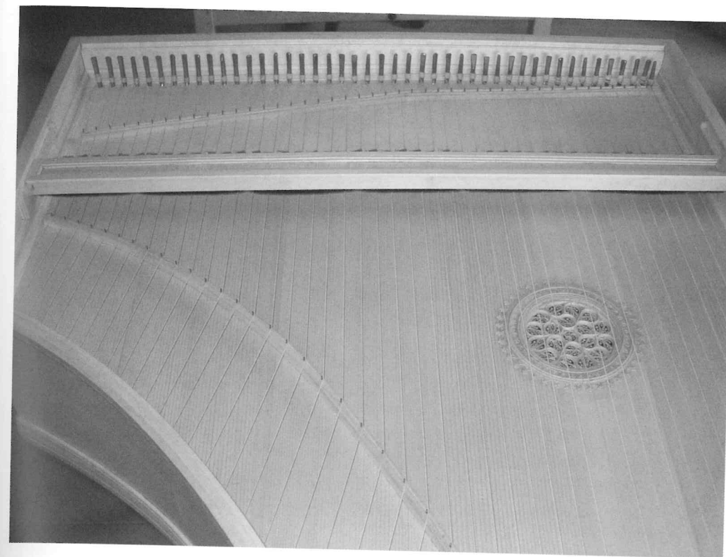
FIG. 5 - Replica del clavicembalo napoletano costruita dall'autore nel 2004. Dettaglio dell'incordatura in minugia.
